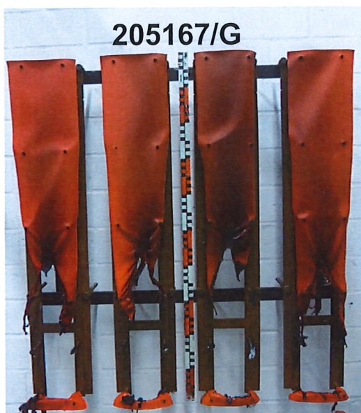
Bild 11: Aussehen der Proben (Probekörper G) nach 10-minütiger Beflammung
