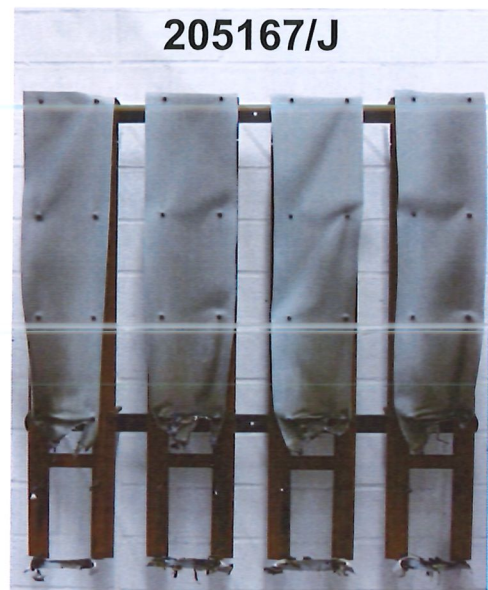
Bild 16: Aussehen der Proben (Probekörper J) nach 10-minütiger Beflammung
