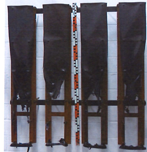
Bild 6: Aussehen der Proben (Probekörper D) nach 10-minütiger Beflammung
