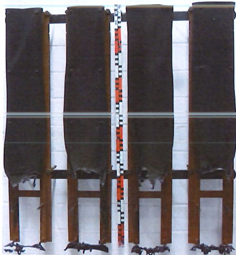
Bild 3: Aussehen der Proben (Probekörper A) nach 10-minütiger Beflammung
