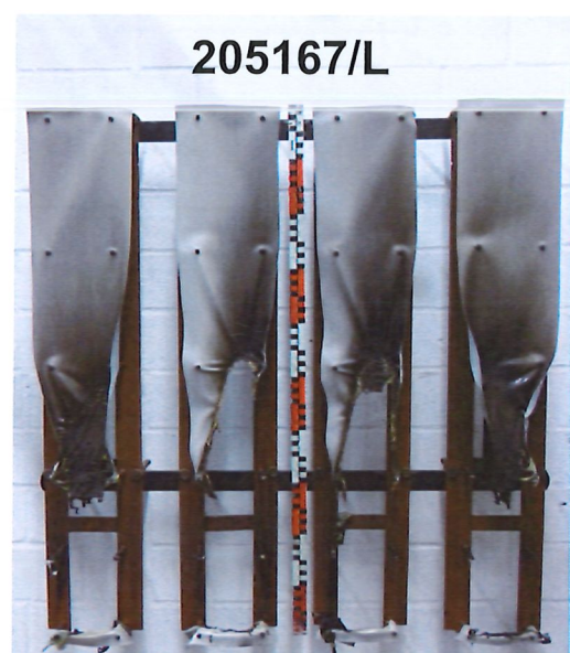
Bild 18: Aussehen der Proben (Probekörper L) nach 10-minütiger Beflammung
