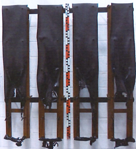
Bild 5: Aussehen der Proben (Probekörper C) nach 10-minütiger Beflammung
