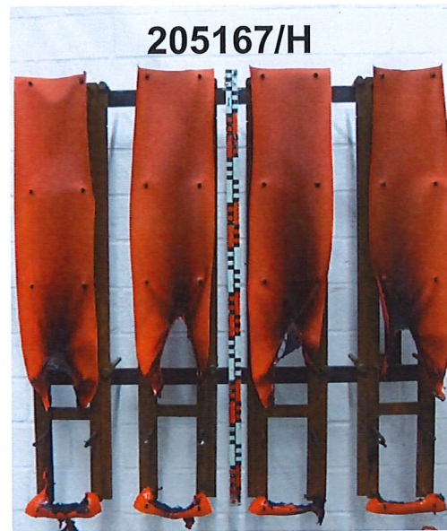
Bild 12: Aussehen der Proben (Probekörper H) nach 10-minütiger Beflammung
